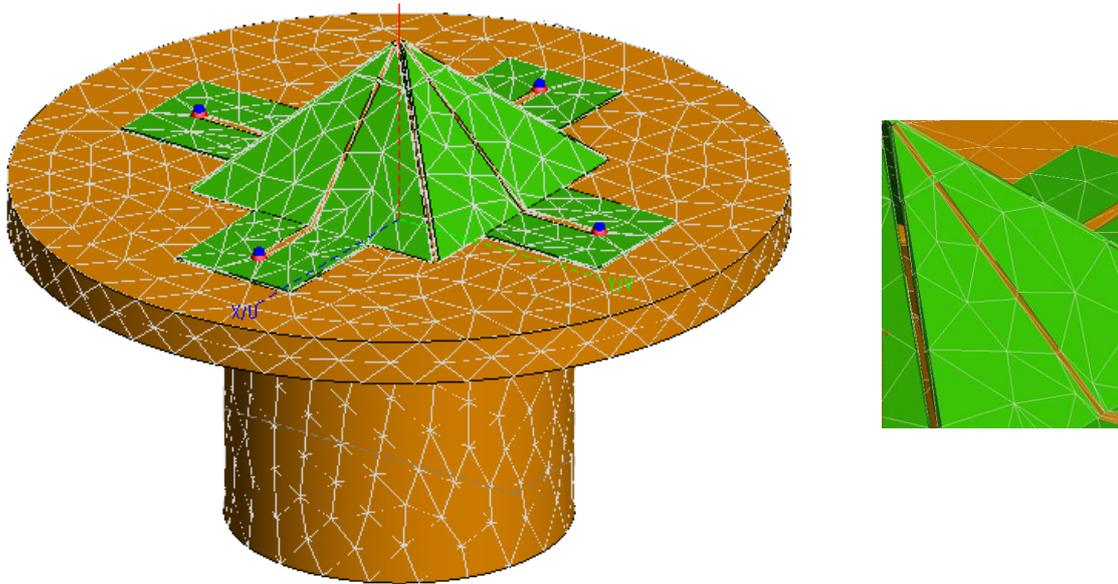
*Figure III-5: L'antenne pyramidale tri-bande pour la 2<sup>ème</sup> bande simulée par FEKO*
