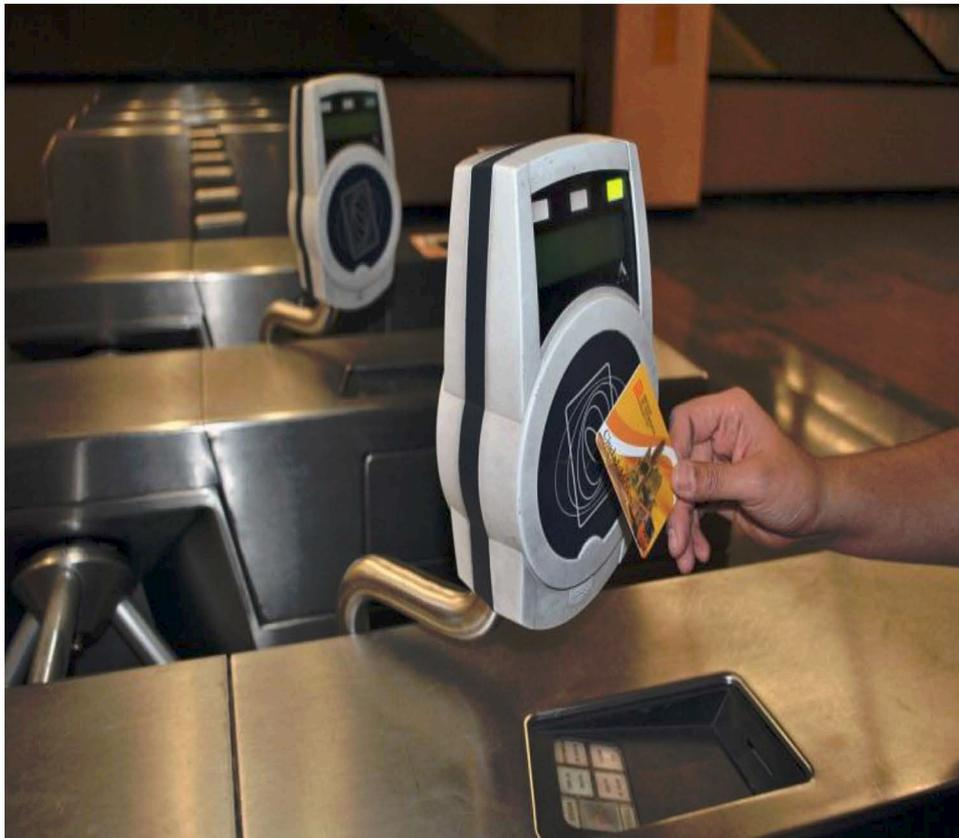
**Figure I.14** : Portillon RFID dans une station de métro.
