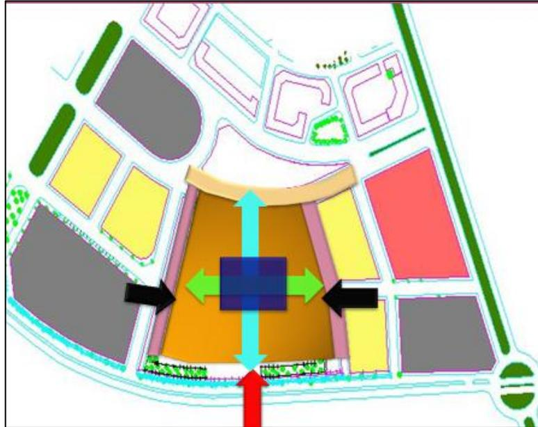
Dans cette étape on a créé l'accès principal depuis l'axe majeur de composition (l'axe principale) sur la voie principale et un accès mécanique depuis l'axe secondaire sur les deux voies tertiaires pour éviter l'embouteillage.
