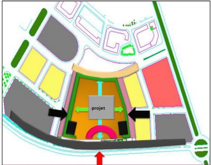
Dans cette étape on a crée une voie de desserte pour faciliter l'accessibilité et pour éviter l'embouteillage dans la voie principale et qui sert à une pose minute pour usagers.
