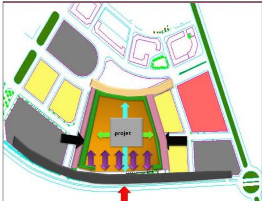
Dans cette étape un reculé de 30 m est prévu par rapport à la voie principale pour réduire la propagation du bruit et pour assurer la sécurité ; de plus une ceinture verte est prévue pour une isolation acoustique et pour des raisons fonctionnelles.
