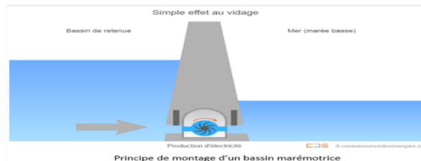
Figure 51. Principe de montage d'un bassin marémotrice.
