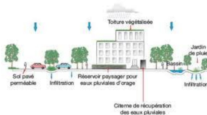
Figure62. Systèmes de récupération des eaux pluviales
