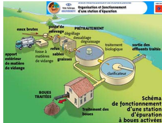
Figure 50. Schéma de fonctionnement d'une station d'épuration.
