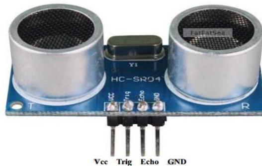
Figure 2.7. Broches de connexion du capteur HC-SR04 [29].
