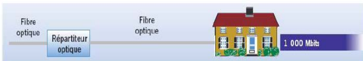
Figure I. 6: Structure d'un réseau FTTH/FTTO.
