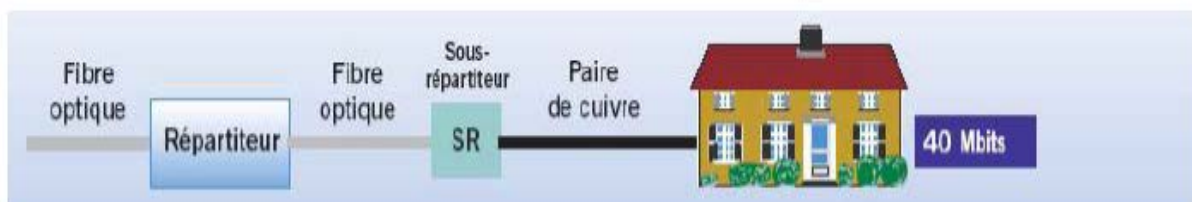
Figure I. 8: Structure d'un réseau FTTC/FTTCab.
