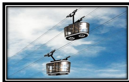
Figure 62 : téléphérique. À deux câbles
