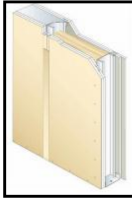
Figure 52: schéma d'une cloison séparative simple parement
