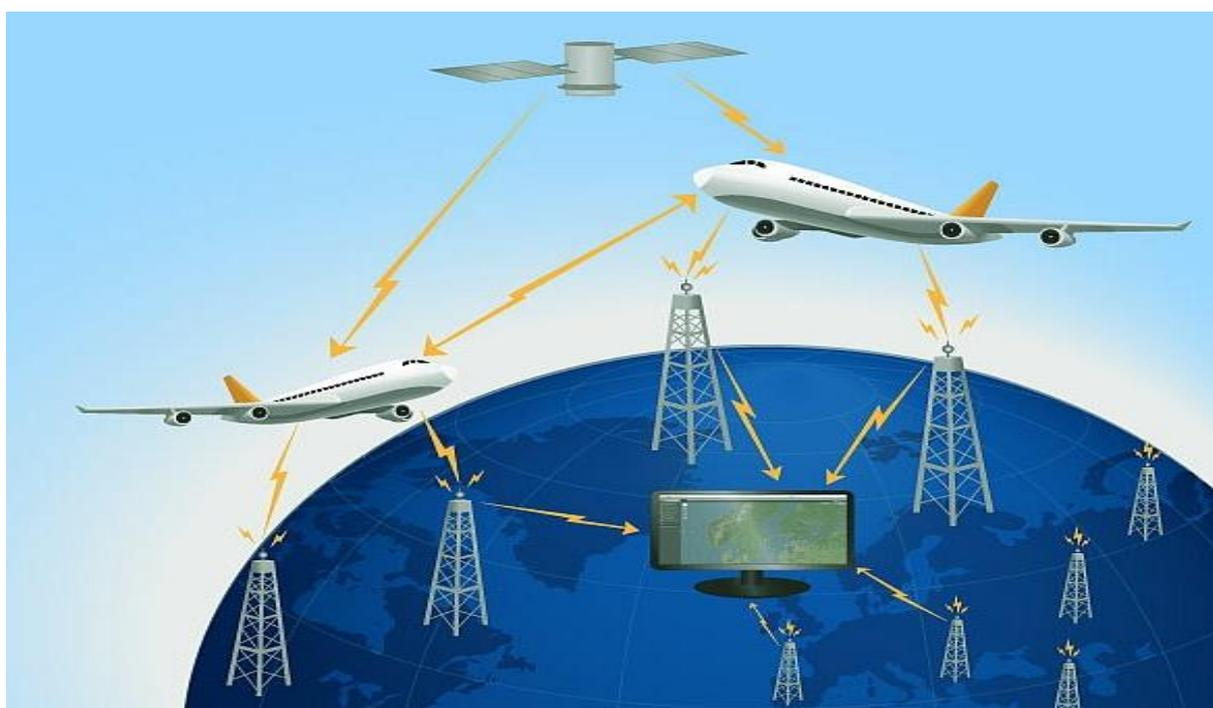
Figure II. 1 : Principe de fonctionnement ADS-B [27].
