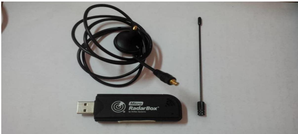
Figure III.1 : La clé micro radar.
