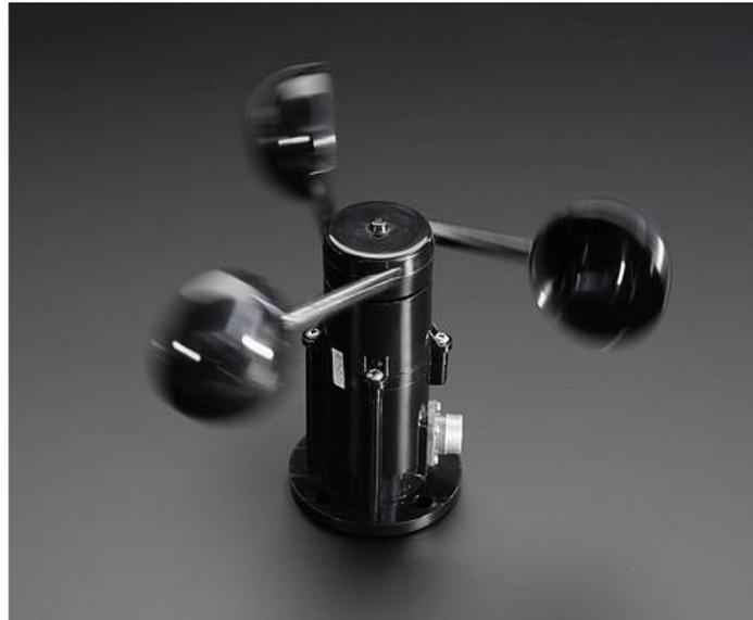
Figure I.19 : Anémomètre à coupelle
