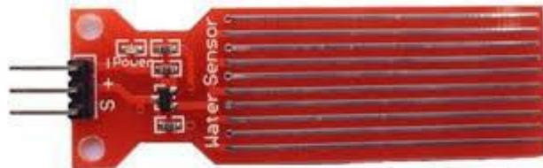
Figure I.11 : Capteur D'eau
