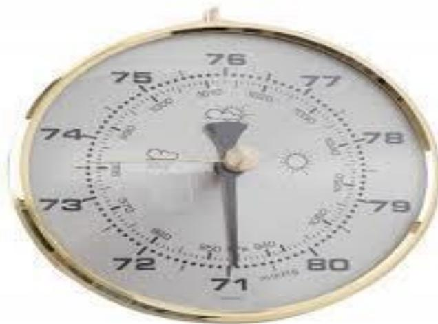
Figure I.17 : Baromètre Anéroïde
