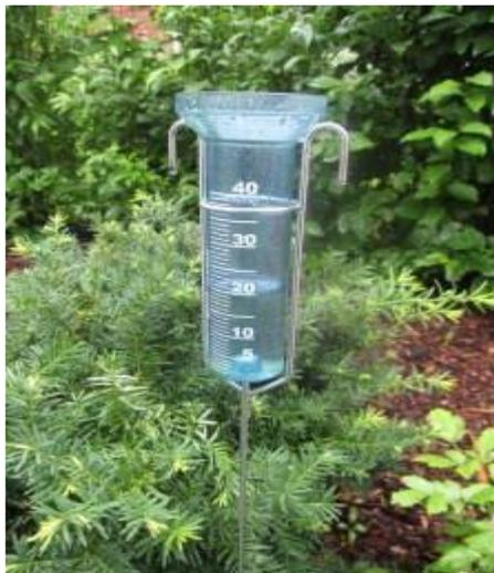
Figure I.18 : pluviomètre à lecture directe
