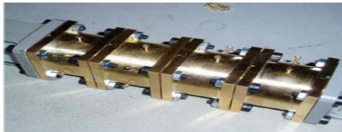
Figure II.24 : Filtre à cavités métalliques cylindriques avec vis de réglage.
