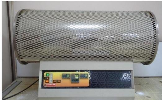
**Figure II.1 :** Image du four de calcination
