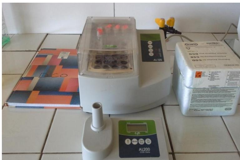
**Figure II.12 :** Photo de l'appareil « AQUALYTIC AL 125 » et son accessoire « AQUALYTIC AL 200 COD Vario »
