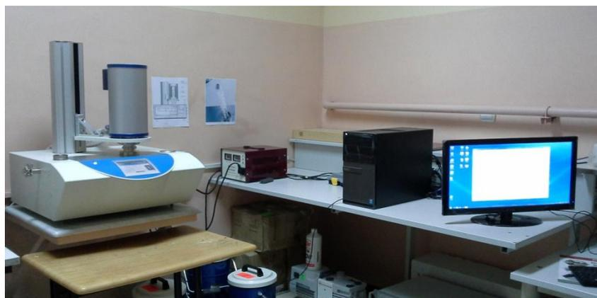
**Figure II.3 :** Photo de l'appareil LINSEIS.STA.PT 1600
