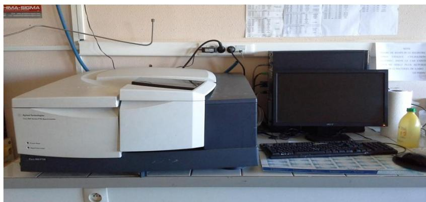
**Figure II.6 :** Photo de l'appareil « Agilent Technologies Cary 600 Series FTIR Spectrometer »
