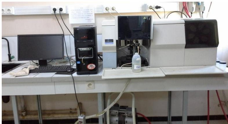
**Figure II.10 :** Photo de l'appareil « Perkin Elmer instrument A Analyst 300 Atomic Absorption Spectrometer »
