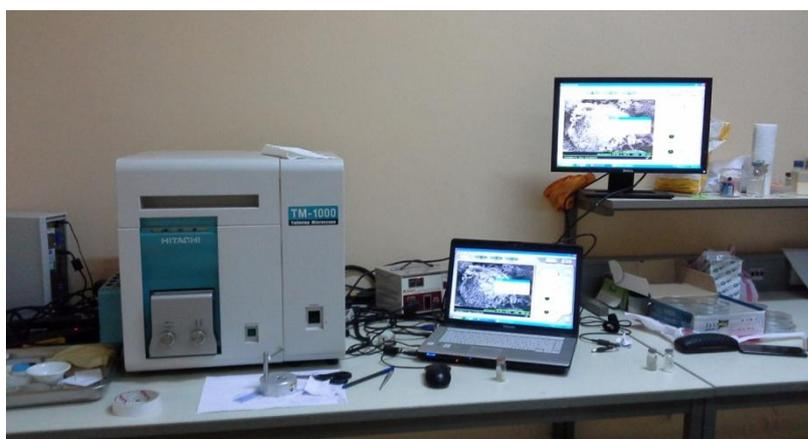
**Figure II.8 :** Photo de l'appareil « HITACHI TM-1000 Tabletop Microscope »
