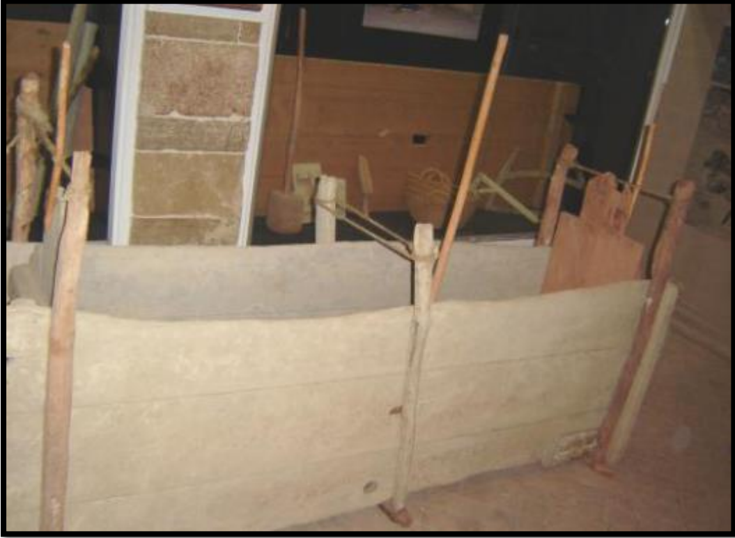
الصورة رقم 30: القالب المستعمل في تقنية الطابية
