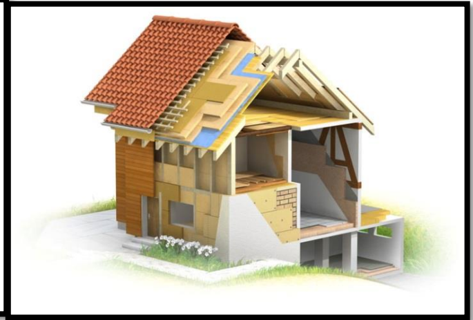
Isolation de mur, sol et toiture.
