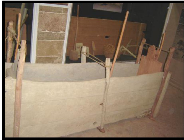
صورة رقم (119): قالب تقنية الطابية-
