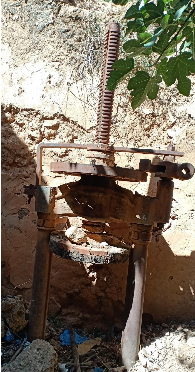
الصورة 24: احدى الهياكل الحديدية المستعملة في رحى أولاد جلااد في تعصير الزيتون.
