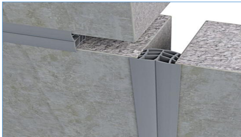
Fig. III.43 : Le joint et le couvre joint
