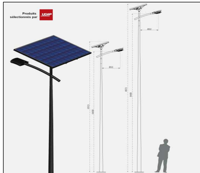
Fig. III.67 : Lampadaires photovoltaïques de 6 mètre d'hauteur
