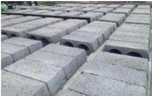
Figure 257 : plancher corps creux.
