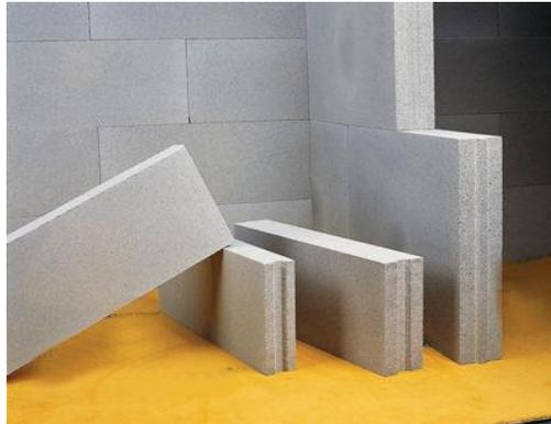
**Figure 202 : béton cellulaire.**
