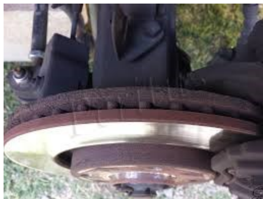
Fig. I-7 :corrosion par frottement
