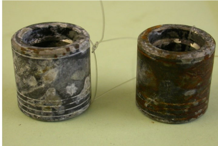
Fig. I-4 : corrosion inter granules
