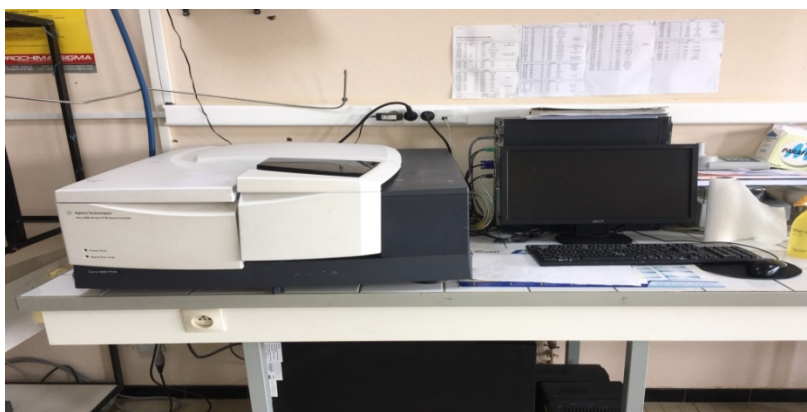
Figure 4 : Appareil de spectroscopie infra-rouge a transformée de Fourier Agilent Technologies Cary 600 series.
