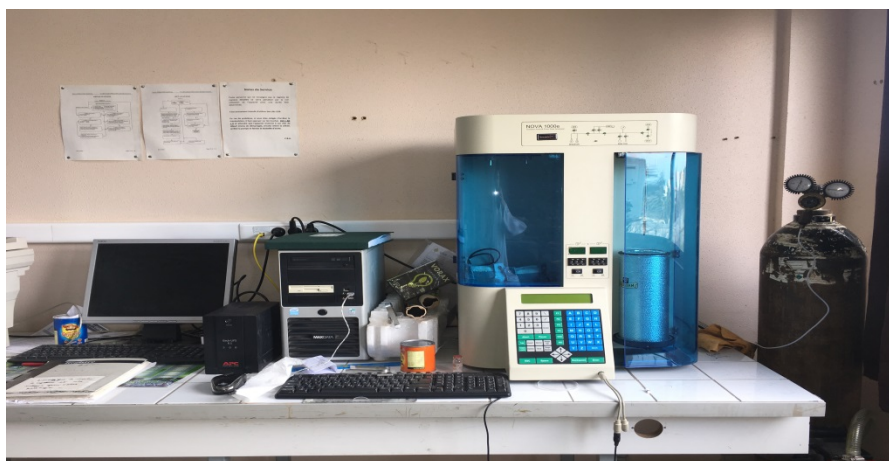
Figure 3 : Appareil d'absorption/désorption d'azote Nova 1000e.
