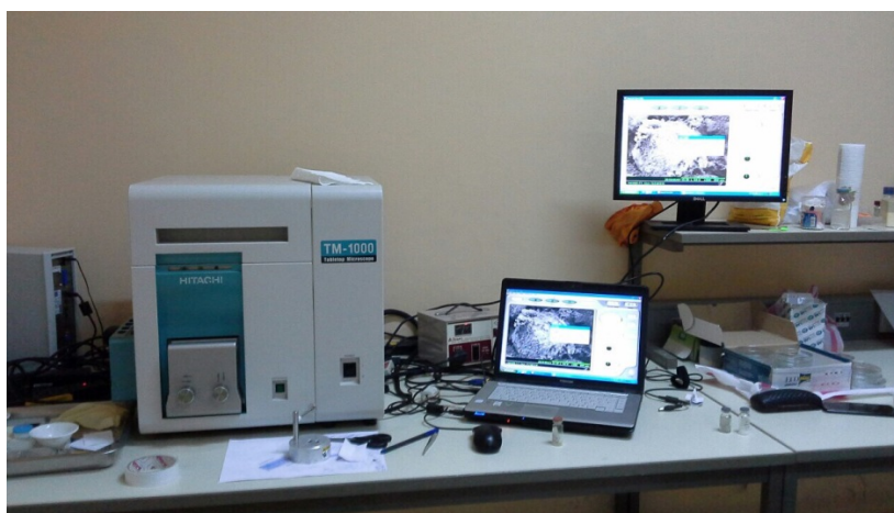
Figure 5 : Appareil de microscopie électronique à balayage.
