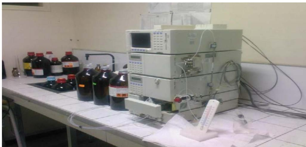
Figure II. 3 : Système HPLC du Laboratoire de Recherche « Spectrochimie et Pharmacologie Structurale ».
