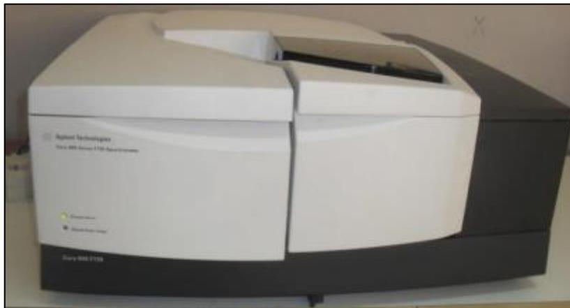
Figure 2.6 : Spectroscopie Infrarouge à Transformée de Fourier (FTIR).
