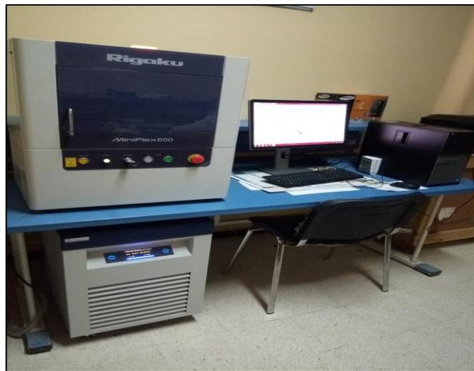
Figure 2.8 : Diffractomètre des rayons X (Rigaku MiniFlex 600)
