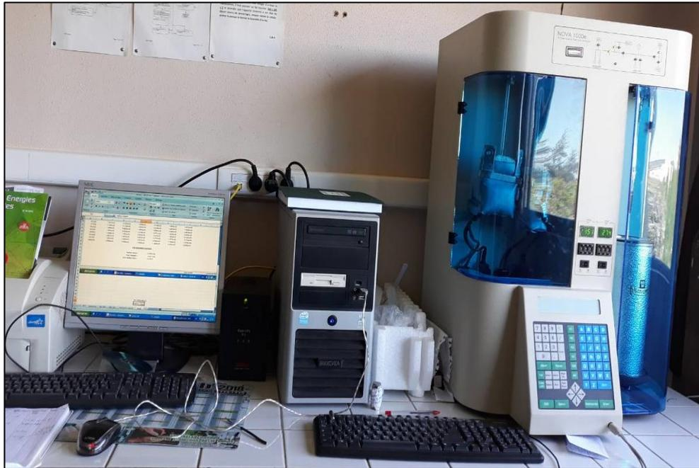
**Figure 2.14** : Appareil BET (NOVA 1000 e)
