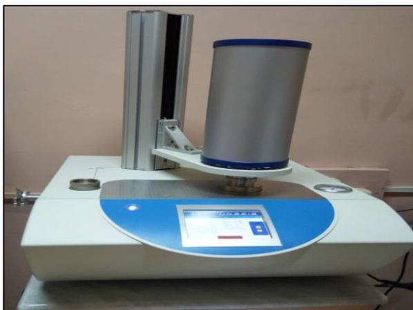
Figure 2.13 : Appareil de l'analyse thermogravimétrique ATG
