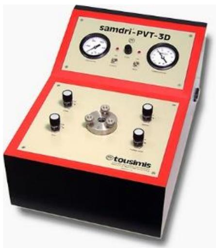
**Fig.II.8.** séchoir à point critique.
