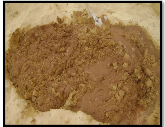
صورة 40: توضح تشكيل العجينة لصنع الطوب.
