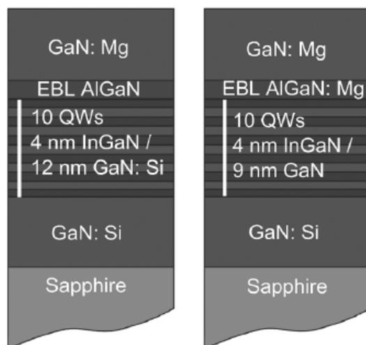
**Figure II.15** : représentation d'une structure PIN à base puits quantique [42]
