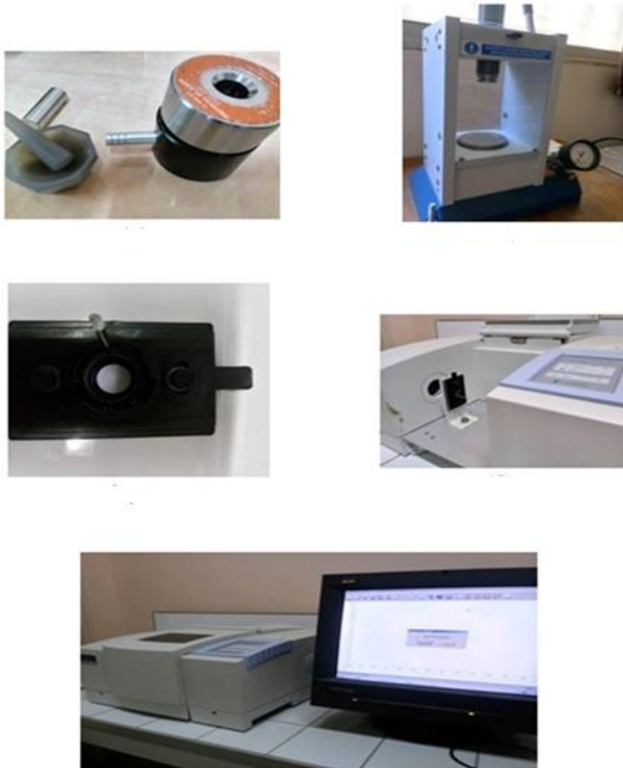
Figure II.1 : Matériel de la caractérisation par FTIR.
