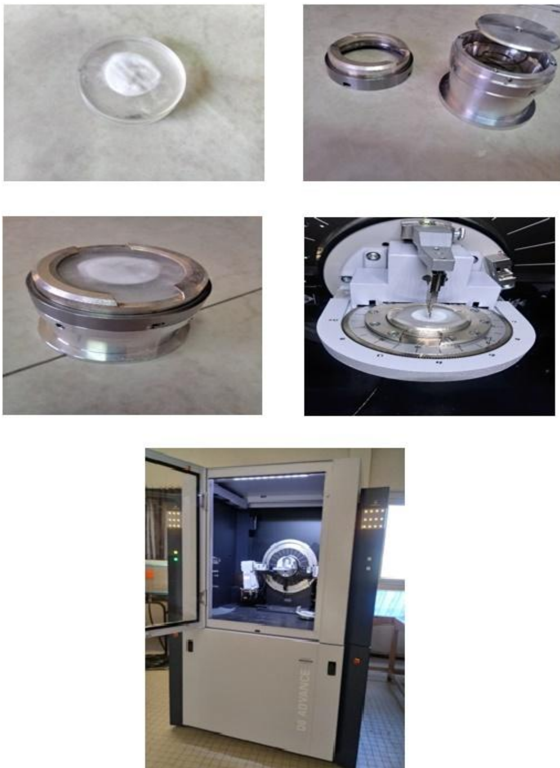
Figure II.4 : Étapes de caractérisation par DRX.
