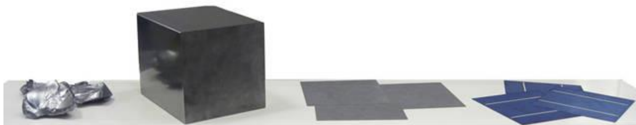
Figure6 : représente des étapes principales pour fabriquer une cellule solaire.
