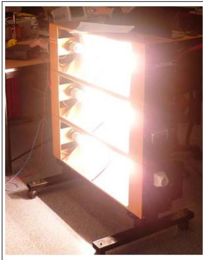
**Figure III. 2: Source lumineuse halogène**
