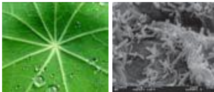
Figure 04: Vues en gros plan à grossissement progressif d'une feuille de capucine révélant la présence de nano cristaux de surface (image à l'extrême droite) 18 .
