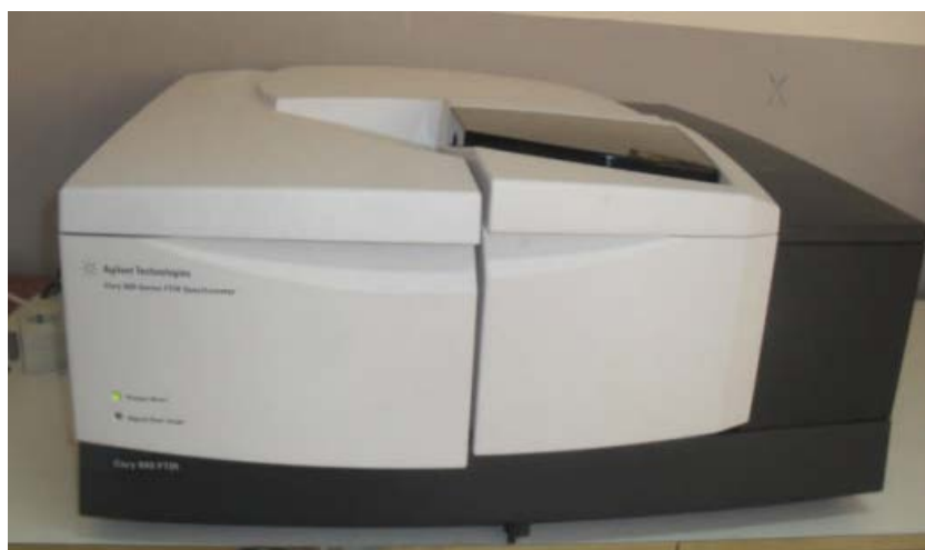
Figure 2. Spectrophotomètre Infrarouge à Transformée de Fourier (FTIR)
