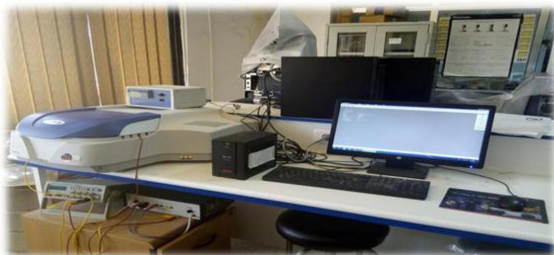
Figure II.3 : Spectrophotomètre UV-visible
