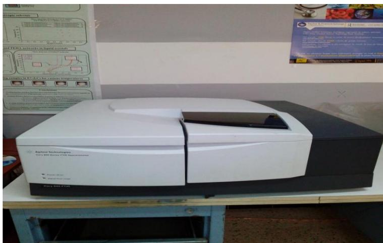
Figure II.1: L'appareil de spectrophotométrie Infrarouge FTIR
