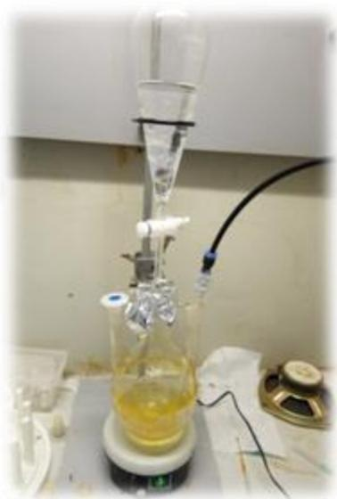
Figure II.4 : (fer / CMC) avant l'ajout de  $\text{NaBH}_4$
