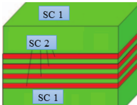
Figure II-2 Structure d'une cellule solaire à bande intermédiaire.
