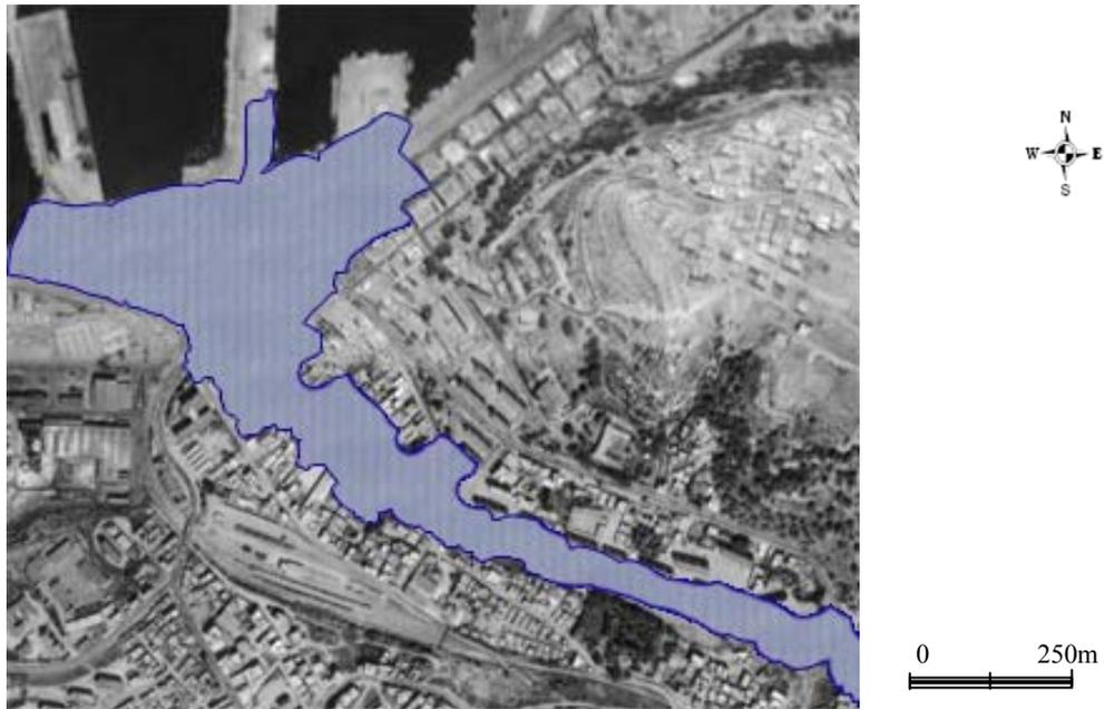
FIG 5.32 Contour brut de la crue centennale
