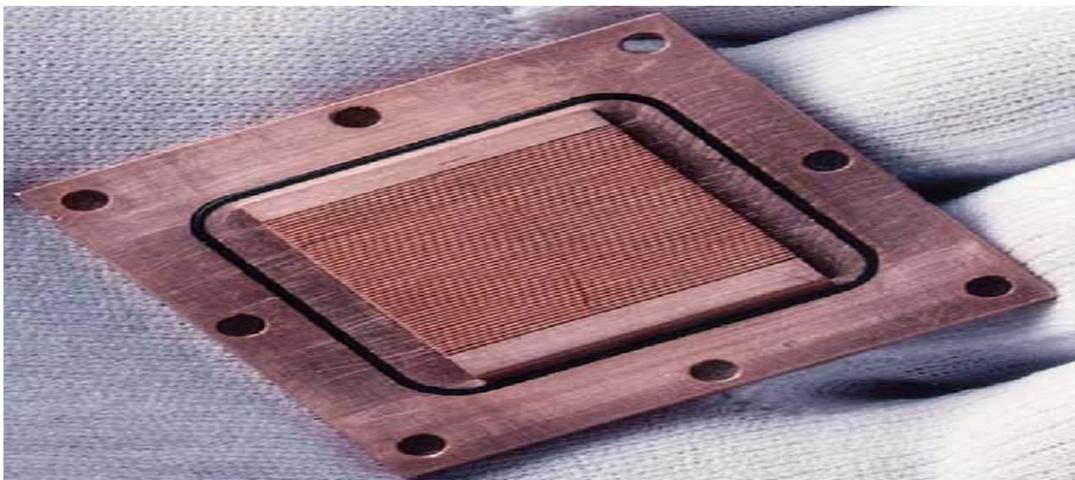
**Figure (II.5) : Mini-échangeur avec Microcanaux de 0.2 mm de largeur**
