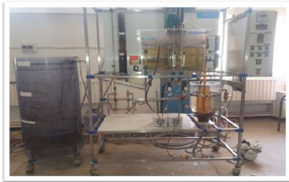
Figure IV.2 : schéma fonctionnel boue activée + lit bactérien et Photo du Pilote TE 900 , descriptif du dispositif expérimental d'amélioration de la qualité des eaux épurées
