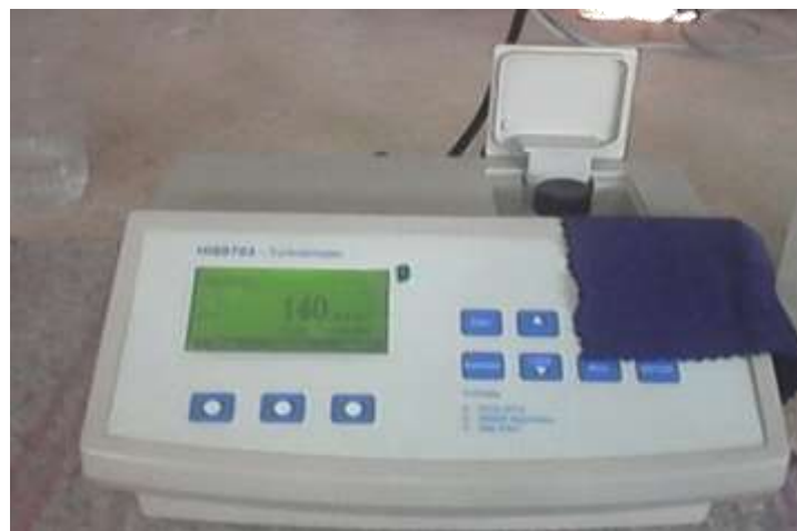
Figure III.12 : Turbidimètre (laboratoire du département d'hydraulique université de Tlemcen).
