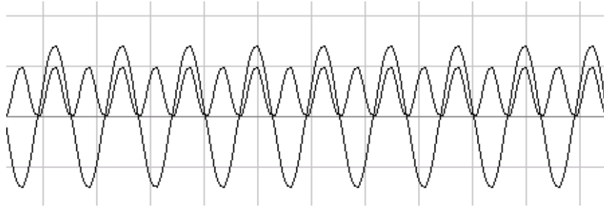
Figure 2.8. Signaux du Multiplicateur AD 633 pour un signal de 40 kHz et 5V.
