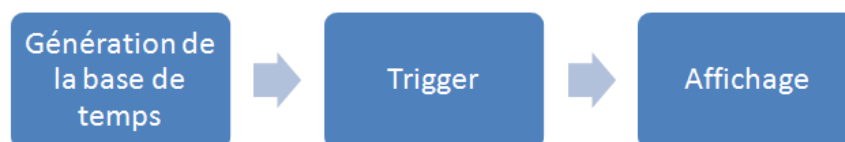
FIGURE 1.1 – Schéma fonctionnel du testeur de temps de réaction.
