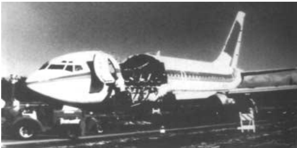
Figure.5 : Rupture de fatigue d'un Boeing 737 (1988) [4]
