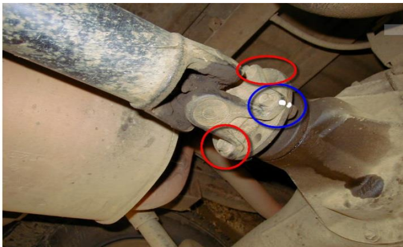
Figure II.10 : Enlèvement des boulons fixant le cardan au pont arrière.
