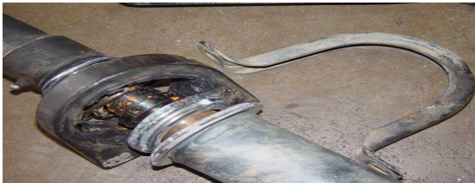
Figure II.2 : usure complète des roulements.
