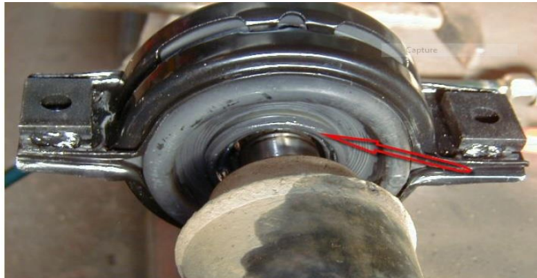
Figure II.18 : La pose du palier central.
