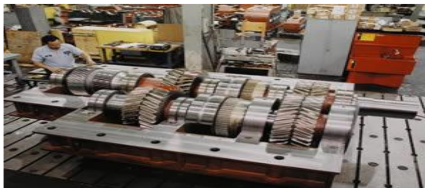
Figure I.2 :Opération de maintenance sur une boîte de vitesse.
