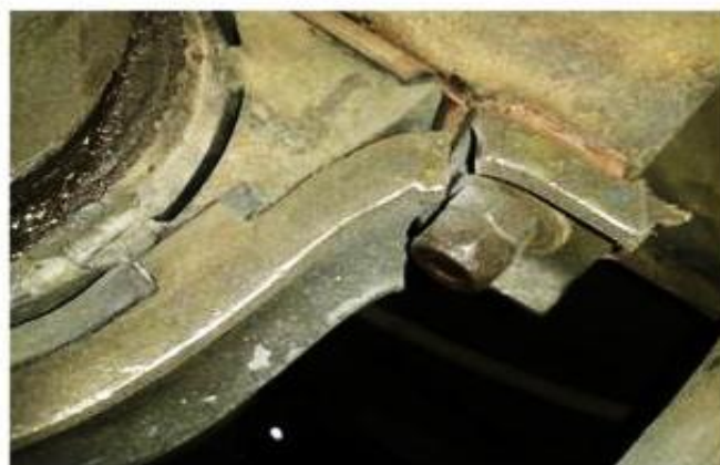
Figure II.3: fissure dans la région de filet en état de marche.
