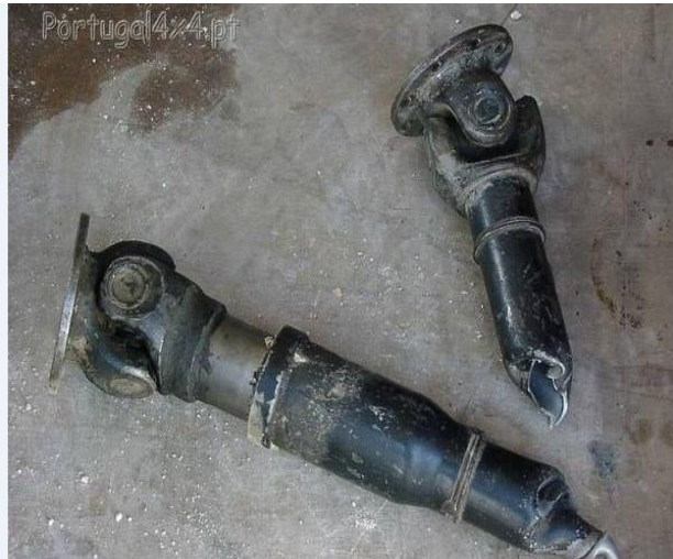
Figure II.7 : Rupture de l'arbre de transmission.
