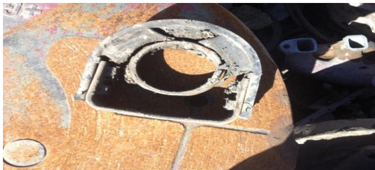
Figure II.4 : défaillance de roulement et de caoutchouc.
