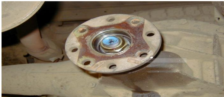
Figure II.22 : tête de pont avec empreinte.
