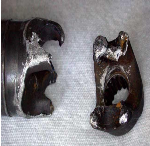
Figure II.6 : Défaillance de U-joint.
