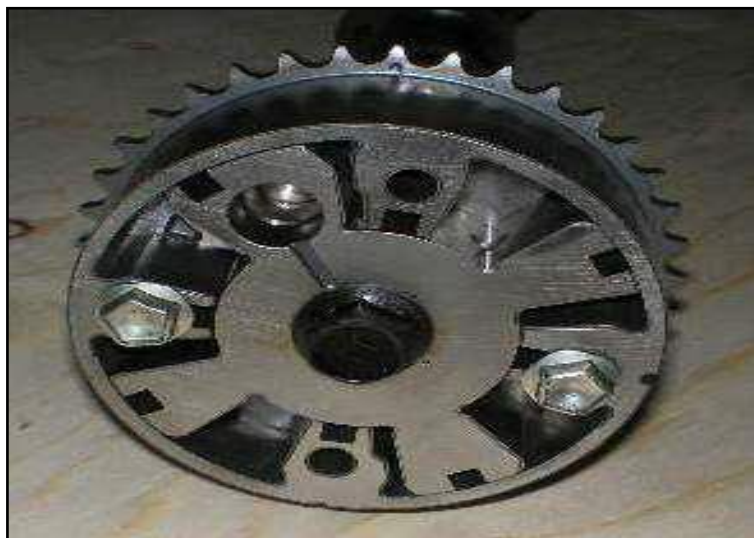
Figure III.11. Système d'avance hydraulique de came [15].
