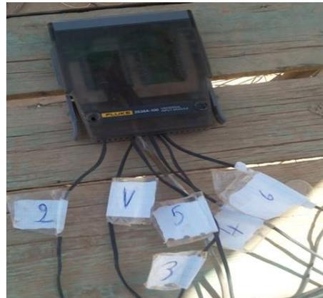
Figure IV.12 Les thermocouples et le module
