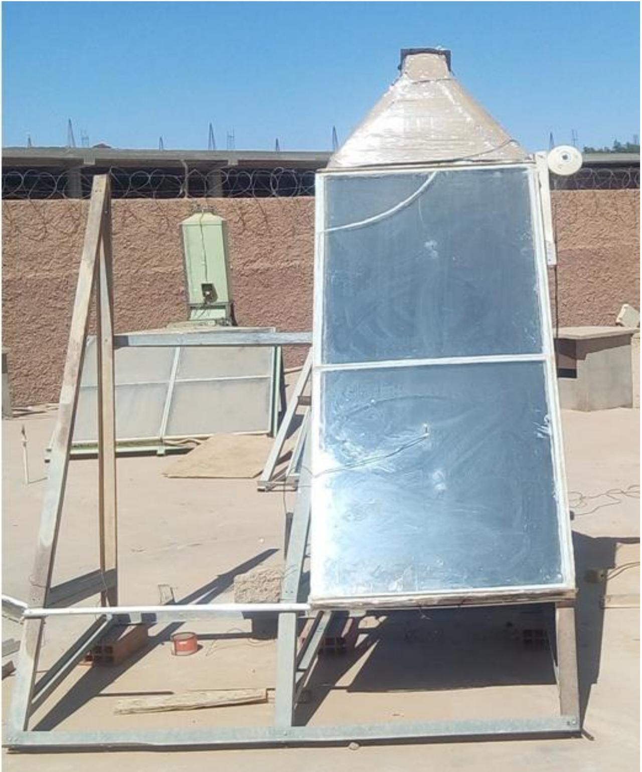
**Figure IV.9** Fixation du capteur sur le support
