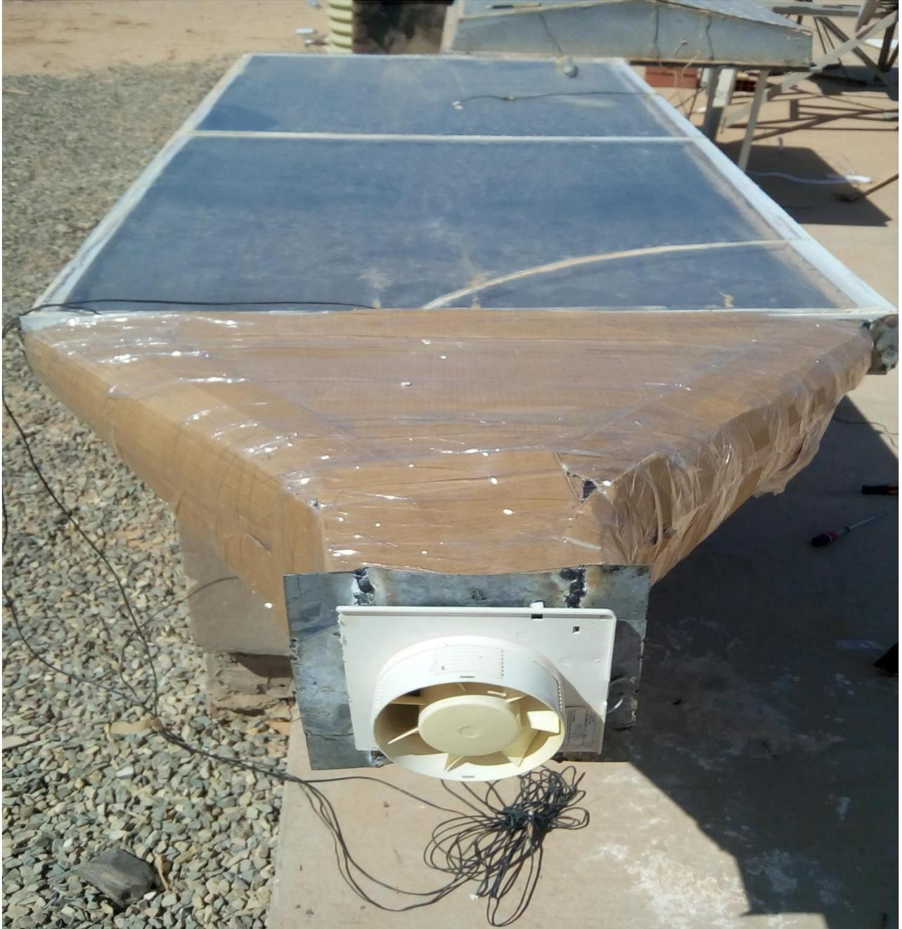
**Figure IV.7 Placement du ventilateur**
