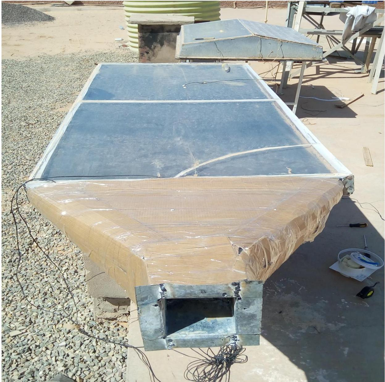
**Figure IV.6 Placement de l'extracteur**
