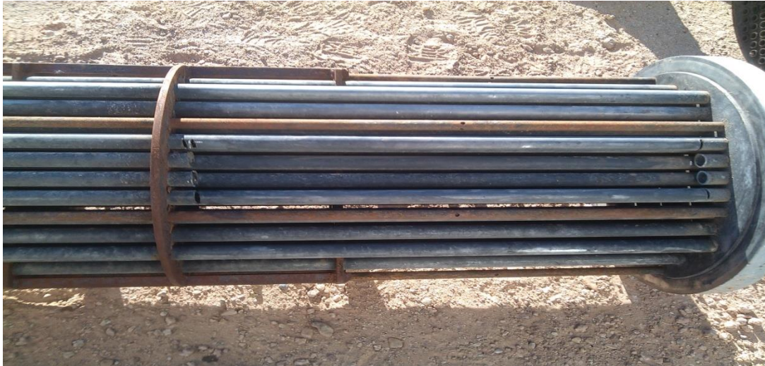
Figure II.23 : Tirants et entretoises (photo réelle)
