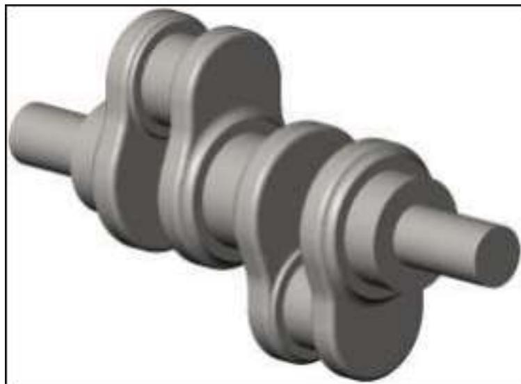
**Figure 5.2 : Vilebrequin 2 cylindres non balancé[22].**
