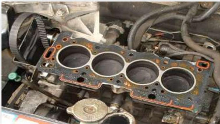
**Figure 1.8 : Joint de culasse[5].**
