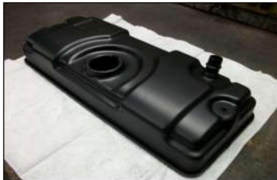
**Figure 1.10 : Cache culbuteur d'un moteur[5].**
