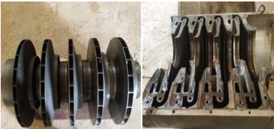
Figure III.17: Compresseur Siemens STC-SV [25]
