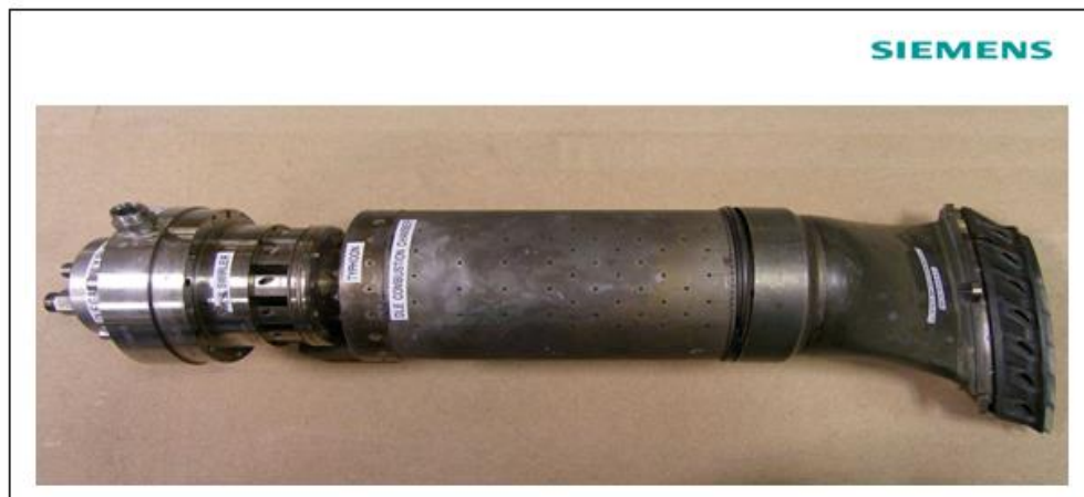
Figure III.6 : Système de combustion DLE d'une SGT-400 [19]
