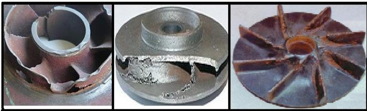
**Figure II.30: Problème de cavitation**
