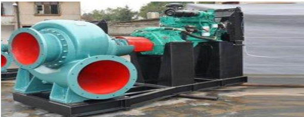
**Figure II.19: Pompe hélico centrifuge horizontal**
