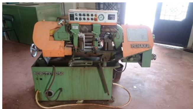
**Figure II.12** : Scie à ruban ROBOTER 250
