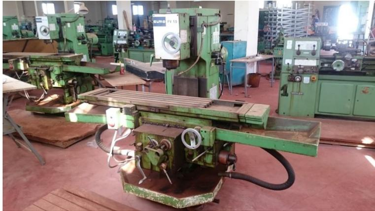
**Figure II.9 :** Fraiseuse verticale ALMO FV 1.5
