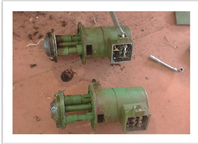
Figure V.5 : Remplacement de l'électropompe défaillant
