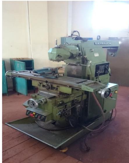
**Figure II.8 :** Fraiseuse universelle FU-1100
