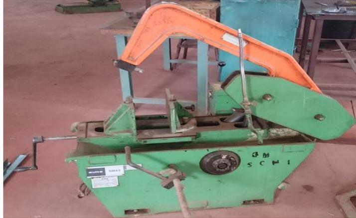
**Figure II.11** : Scie alternative à ruban SM A3
