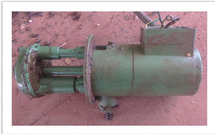
Figure V.4 : Moteur de refroidissement MA2 (électropompe) de tour SN50
