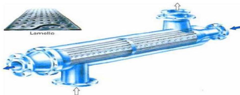
Figure 1.10 : Echangeur lamellaire. [1]
