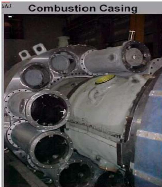
**Figure (II.20) :** *Enveloppe de combustion*
