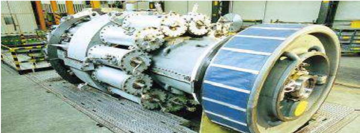
Figure (II.15) : Turbine à gaz MS 5002C.
