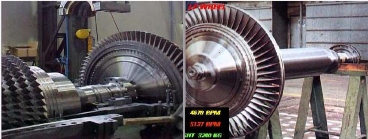
**Figure (II.26) :** Roue de turbine HP
