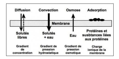
Figure 13 : Les principes de bases de la dialyse [71].
