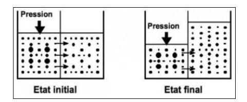
Figure 12: Transfert d'eau et de solutés par convection [70].
