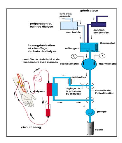
**Figure 16 :** Générateur de dialyse couplé à la circulation sanguine et la circulation du dialysat **[80]**.
