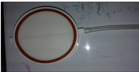
Figure II 6: Membrane placée sur la surface de la filtration et joint positionné
